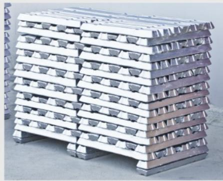
Döküm işlemi bittikten sonra hazır hale gelen alüminyum külçeler, istiflenerek sevkiyata hazır hale getirilir.
