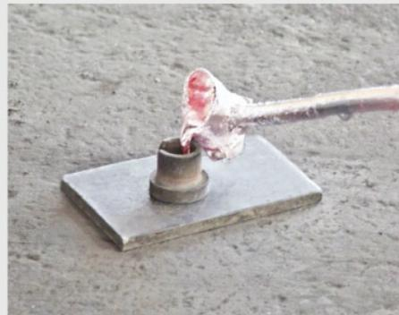
Ergyen alüminyum iyice karıştırılıp, gazi alındıktan sonra temiz bir şekilde numune kepçesi ile numune alınarak, titizlikle kalıba dökülür.
